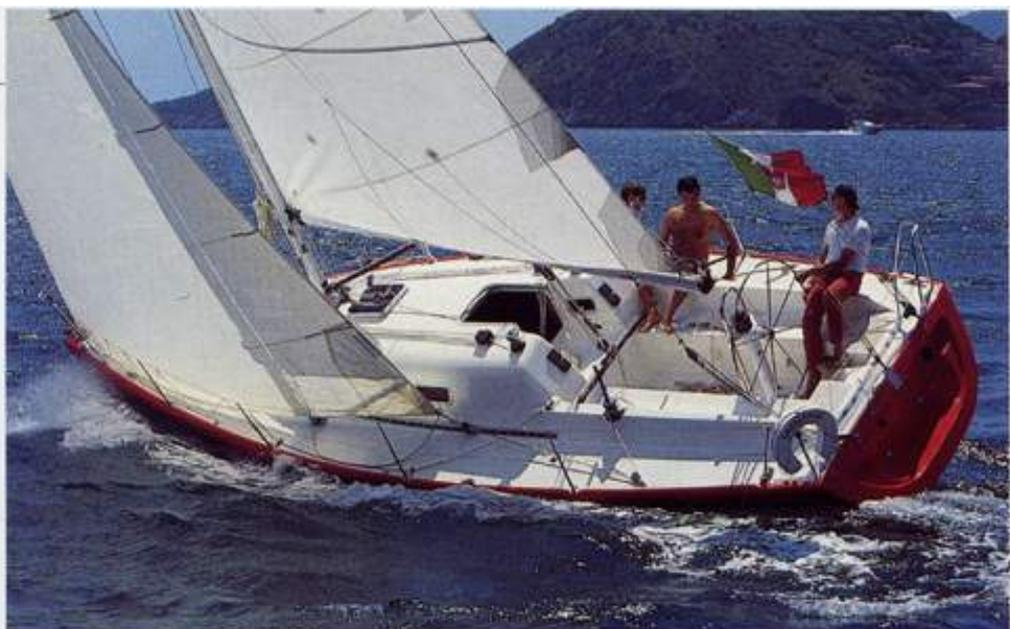
*Basta osservare la scia di poppa e la poca onda creata per accorgersi della bontà della carena del Match 33, un dieci metri dai parametri di progetto molto spinti, ma con una apprezzabile abitabilità interna frutto delle larghe sezioni della poppa. Leggera ma molto rigida la costruzione in composito.*
