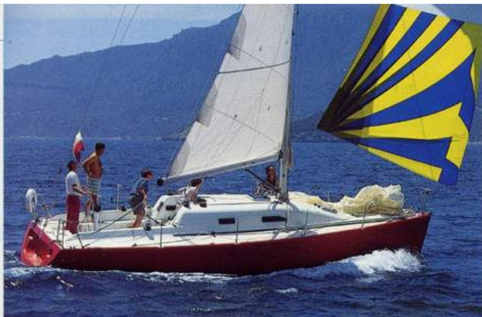
*Durante la prova, che si è svolta con sedici nodi di vento reale, il Match 33 ha più volte superato la sua velocità critica, planando con l'MPS a 9 nodi. In bolina, malgrado avessimo a riva un genoa leggero anche se grasso, ha mantenuto un assetto corretto e un ottimo angolo al vento.*
