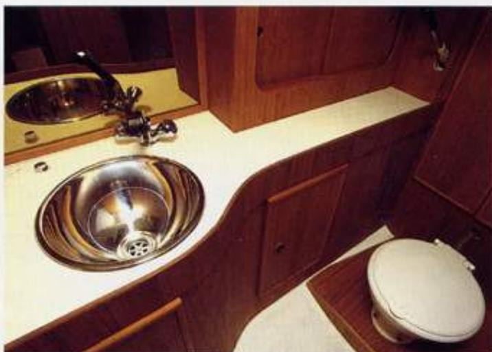
*La posizione sul baglio massimo esalta l'agibilità della toilette, dove sono ricavati tre grandi stipetti e un armadio cerate. La parte bassa è realizzata da un controstampo stagno di facile pulizia.*
